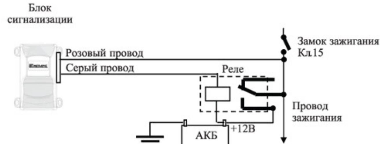
**Подключение нормально разомкнутого реле блокировки**
